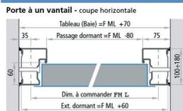
Dormant pour pose en tunnel pour portes Proget multi-usage, à trois côtés et à assembler par des angles à 45°, en acier galvanisé à chaud selon le procédé "Sendzimir" épaisseur de 1,25 mm. A visser sur cloison finie grâce à 6 pattes fournies, y compris les joints d'assemblage, les caches de vis et le thermolaquage en RAL par poudres époxy-polyester. Les trous de fixation sont déjà prévus. Vis de fixation non fournies.
