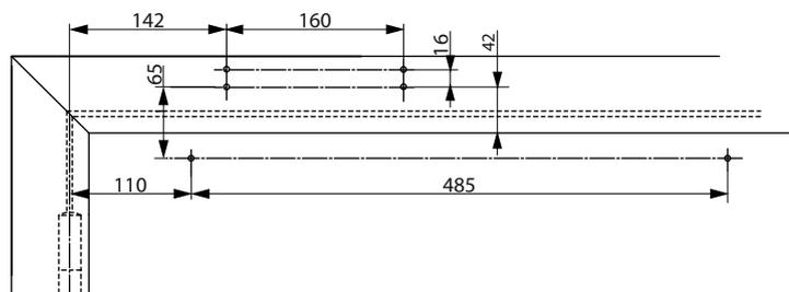
Dimensions en cas d'utilisation avec plaque de montage plate pour un montage sur l'huissier côté opposé aux paumelles
