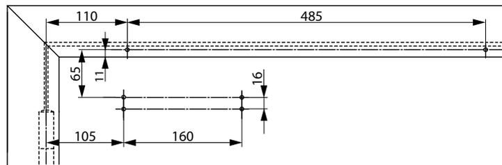
Dimensions en cas d'utilisation avec plaque de montage plate pour un montage sur la porte côté opposé aux paumelles
