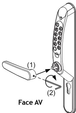
En fonction de l'épaisseur de la porte, choisir l'un des 3 carrés creux associés à sa tige filetée (voir guide échelle 1 page suivante).
