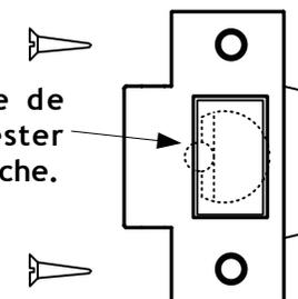
Il est possible de rattraper un jeu exagéré d'alignement gâche-pêne par la pose sur la face intérieure du recouvrement de l'hubriserie de tampons en élastomère.
