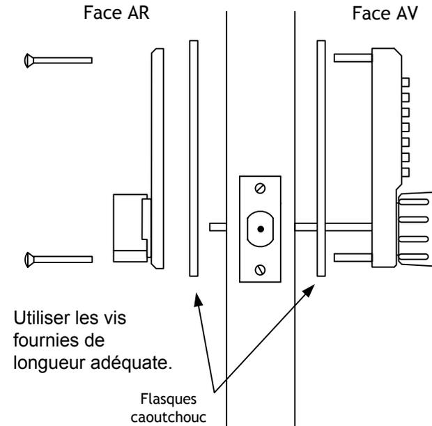
Fixer les deux parties sur la porte avec les flasques en caoutchouc et 2 vis.
