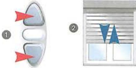
3 - Vérifier le sens de rotation en appuyant sur **montée OU descente** ①. Si le sens est inversé ② appuyer sur la touche **stop** jusqu'à avoir un bref mouvement ③ puis vérifier à nouveau.
