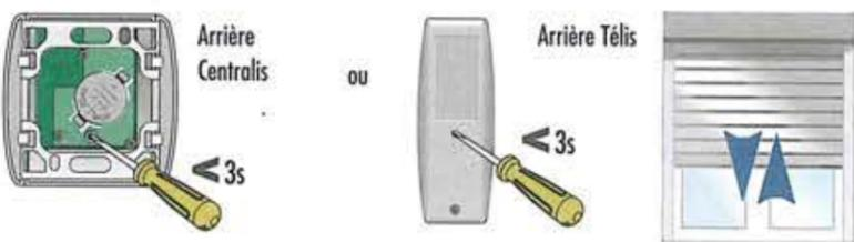
2 - Appuyer sur la touche réinitialisation du nouvel émetteur à programmer ou à supprimer, le volet fait un bref mouvement.
