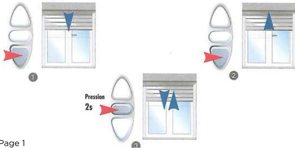
4 - Faire descendre le volet en fin de course basse désirée ①. Appuyer sur **stop ET montée** en même temps : le volet déclenche la montée ②, lâcher et stopper le volet en fin de course haute ③.
