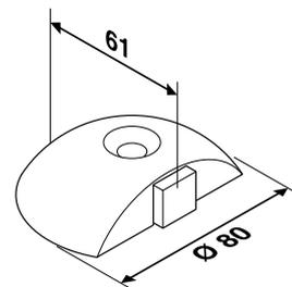
La butée de sol est destinée à éviter la détérioration de la penture et du ferme-porte ou du pivot de sol. Elle est indispensable avec les pivots de sol de la série Sevax TS.
