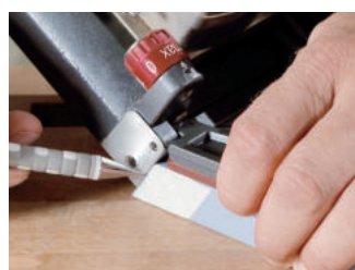
1. Fraiser et repérer le milieu du fraisage
