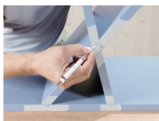
2. Transférer le repère central sur la deuxième pièce à usiner
