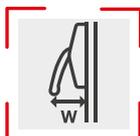
**Grade 1 :** Projection de la barre (W) jusqu'à 150 mm (projection importante).
