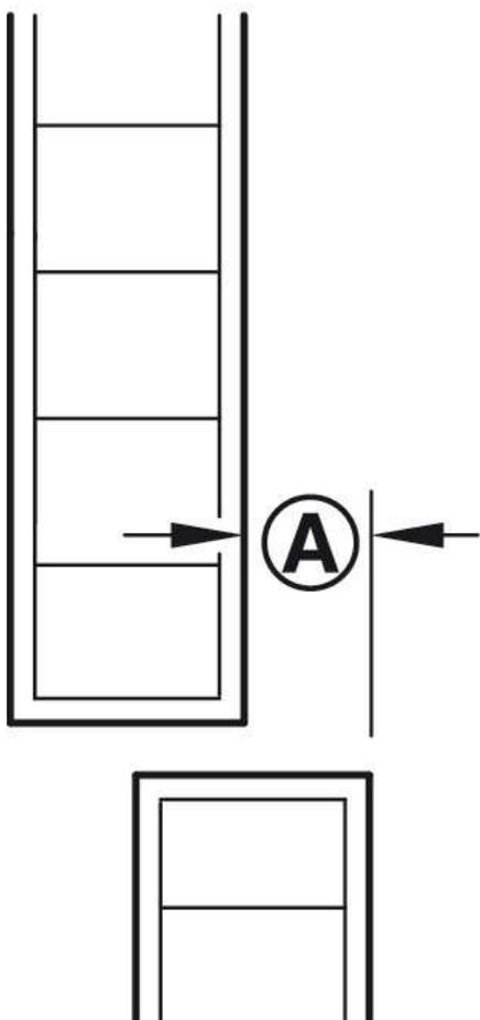
Pour monter la porte, utiliser des charnières à corps à angle d'ouverture de  $95^\circ$  et retrait de la porte 8 mm max.
