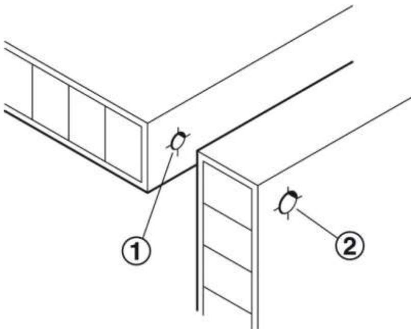
Perçage 1 : Trou borgne avec diamètre nécessaire.
