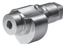
La came symétrique en forme de cœur et l'entraînement linéaire du TS 90 Impulse DORMA offrent à l'utilisateur un grand confort d'utilisation grâce à une résistance à l'ouverture immédiatement dégressive. Pour les enfants, les personnes âgées et les handicapés, ouvrir
