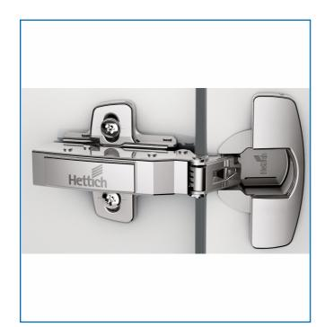
CHARNIÈRE AMORTISSEUR -SENSYS 8645I - 110° - NICKELÉ -ENTRAXE : 52 ET 45 MM
