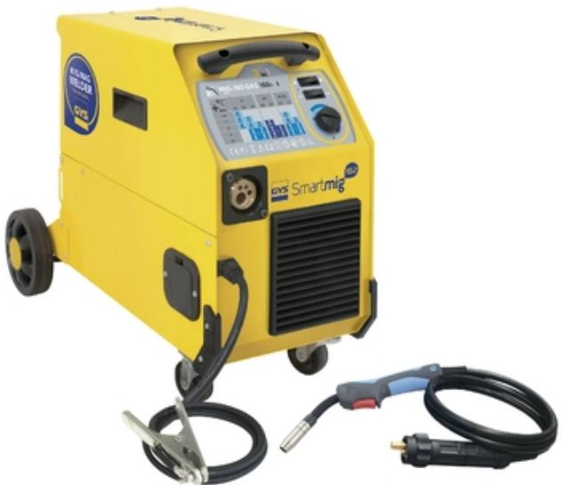
Poste de soudage avec ou sans gaz : Smartmig 162. Semi-automatique. Réglage simple et rapide, idéal pour les artisans et particuliers. Sur roues. Pour souder l'acier, l'inox et l'aluminium. Utilise 2 procédés : Avec gaz (MIG/MAG) pour un soudage en atelier avec du fil plein de diamètre 0,6, 0,8 et 1 mm. Sans gaz (NO GAZ) pour un soudage à l'extérieur avec du fil fourré de diamètre 0,9 et 1,2 mm.
