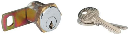
Batteuse PTT. Fonctionne sur passe PTT. Livrée avec came plate 51 x 20 mm, écrou et 2 clés. Corps laiton - Mécanisme à goupilles - Filetée, épaisseur 23 mm.
