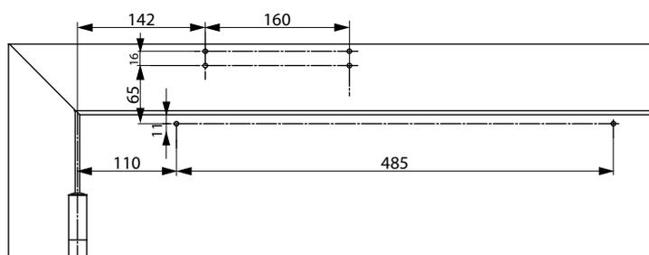
Dimensions en cas d'utilisation avec plaque de montage plate pour un montage sur l'huissierie côté paumelles
