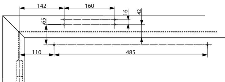
Dimensions en cas d'utilisation avec plaque de montage plate pour un montage sur l' huisserie côté opposé aux paumelles
