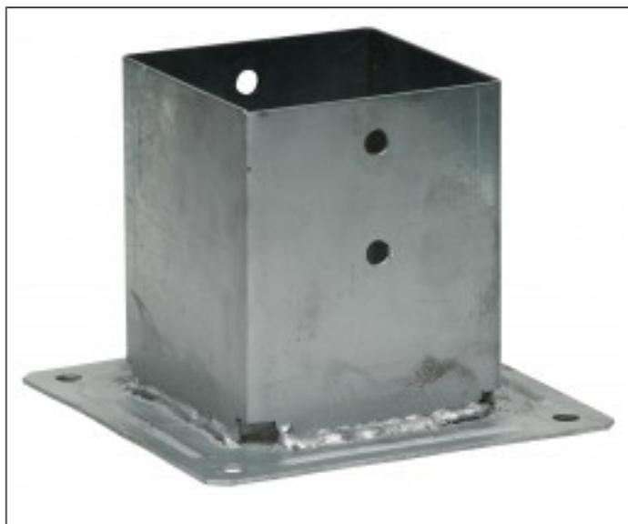
Les pieds de poteau carrés sur platine PPJBT sont préconisés dans la réalisation de petits ouvrages tels que les clôtures et structures légères de jardin. Très faciles à démonter, ils peuvent être boulonnés sur support béton et acier ou visser sur bois.
