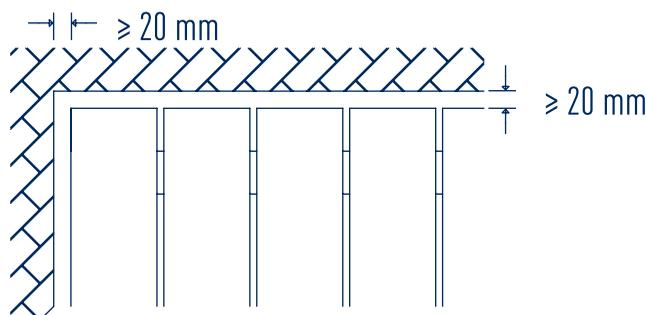
En cas de raccordement de la terrasse sur un élément d'extrémité, un écart de  $\geq 20$  mm doit être respecté, afin que les joints ne soient pas obstrués par des salissures ou par des altérations des lames. La libre évacuation de l'eau doit être garantie en continu sur et sous la terrasse.
