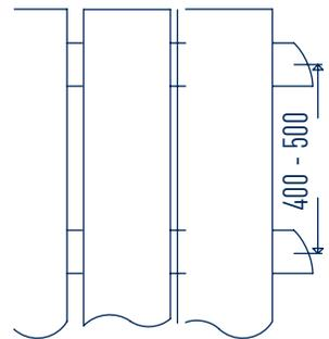
L'écart entre les joints doit être d'au moins 7 mm ou 6% de la largeur des lattes pour les lattes de 90 à 120 mm de large!
