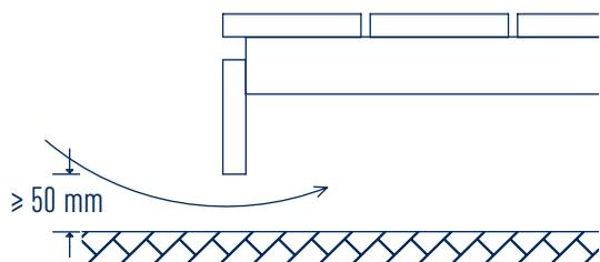
Dans le cas d'un raccord latéral de la terrasse avec une planche de couverture, il faut respecter une ouverture d'arrivée d'air de  $\geq 50$  mm (en continu) pour l'aération de la construction. La planche de couverture ne doit pas toucher le sol.
