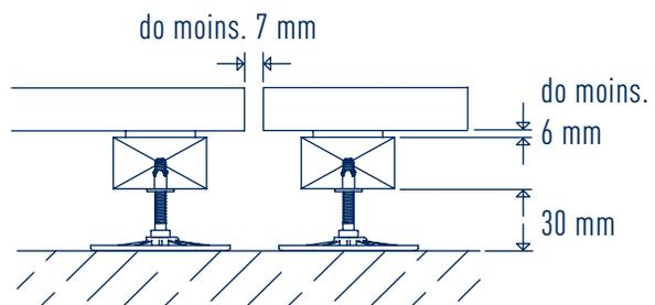
La variante avec aboutement ne doit jamais être réalisée sur le support et doit toujours présenter un écart d'au moins 7 mm !
