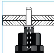
4 - Insérez la tige du rivet dans le nez **2** de la pince et le corps du rivet dans le percement des éléments à assembler.
