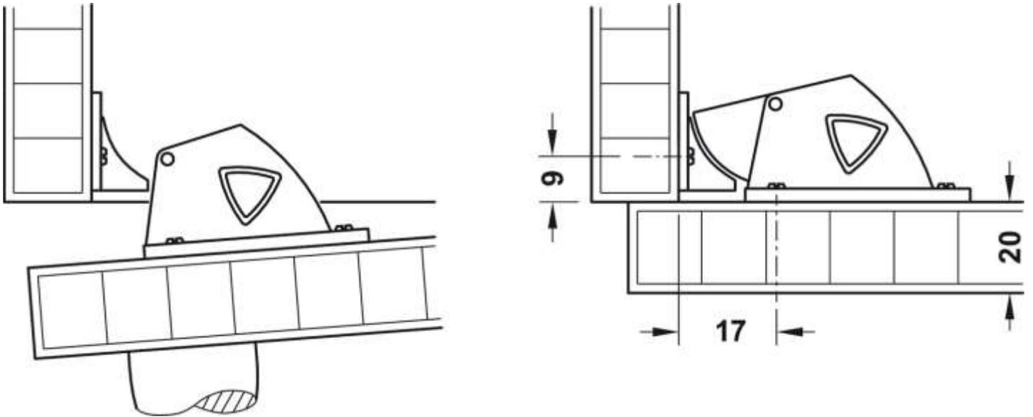
En présentant le bouton aimanté, le bec de canne se retire et il est alors possible d'ouvrir la porte. Lors de la fermeture, la porte enclenche le bec de canne et la porte est verrouillée.
