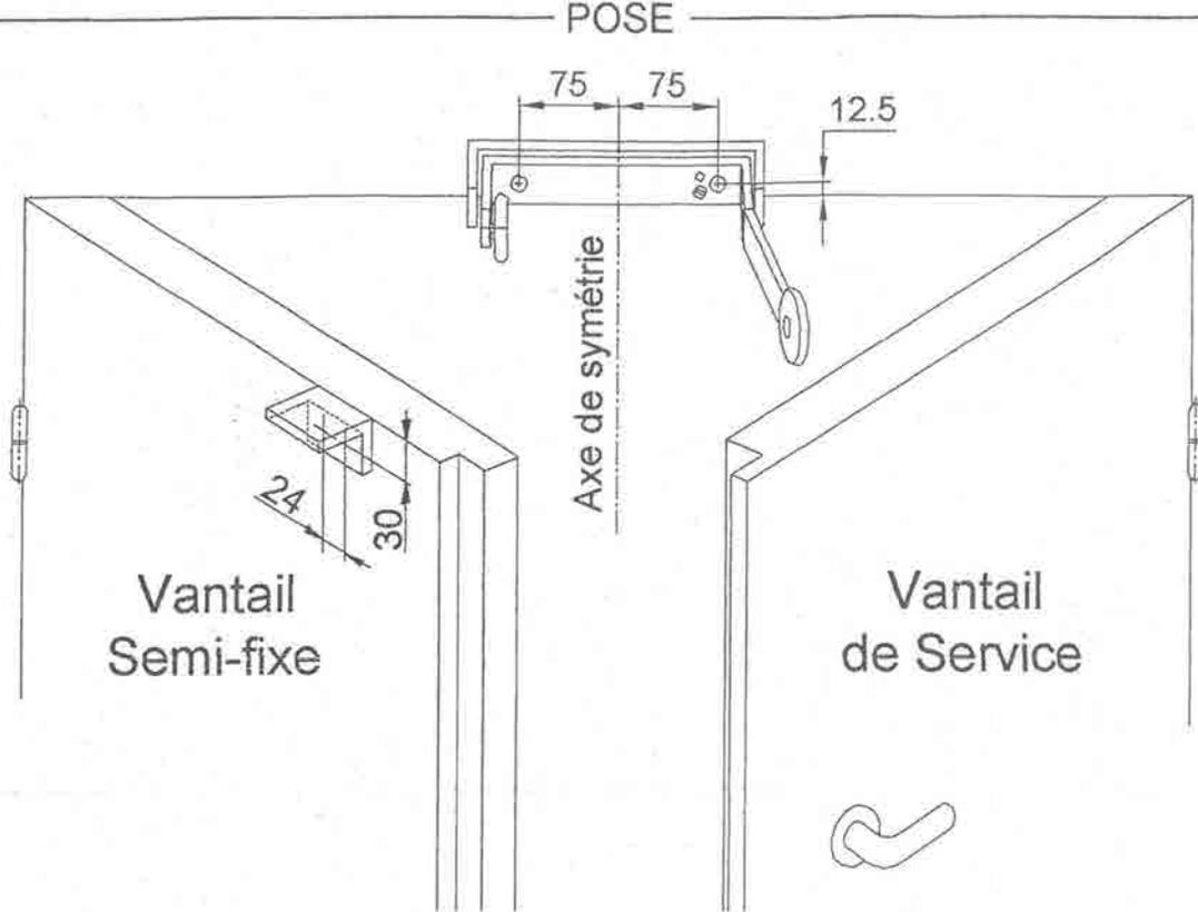
NOTA : L'appareil est réversible suivant le sens de fermeture des vantaux.
